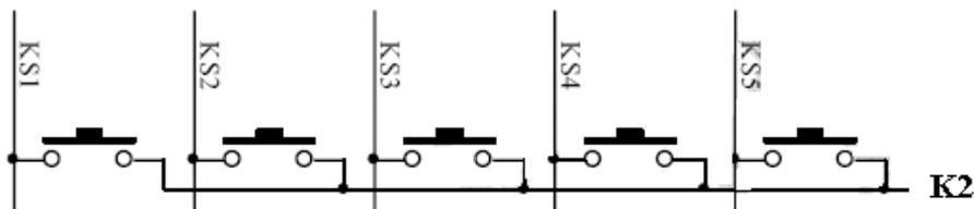
键扫数据储存地址如下所示，先发读键命令后，开始读取按键数据 BYTE1—BYTE5 字节，读数据从低位开始输出，其中 B6 和 B7 位为无效位，此时芯片输出为 0。芯片 K 和 KS 引脚对应的按键按下时，相对应的字节内的 BIT 位为 1。
