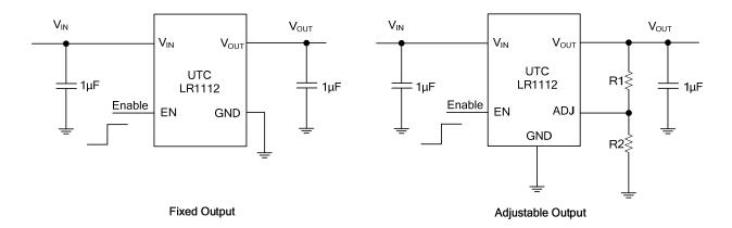
$$V_{OUT} = V_{REF} \left(1 + \frac{R1}{R2}\right)$$
